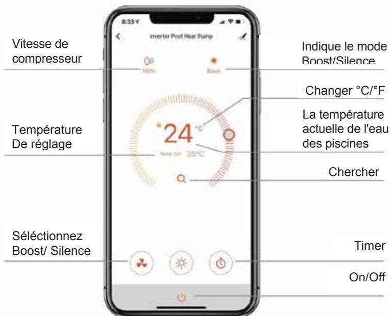
2. Pour les pompes à chaleur avec fonction de chauffage et de refroidissement:
